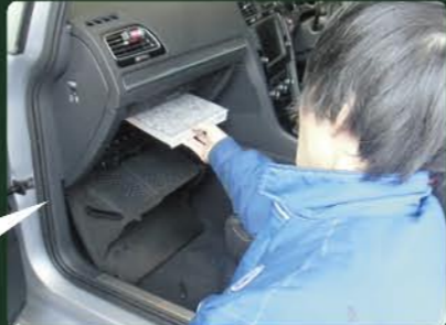
1年ほど使用したポーレンフィルター。目詰まりしてくると浄化性能が低下します。
