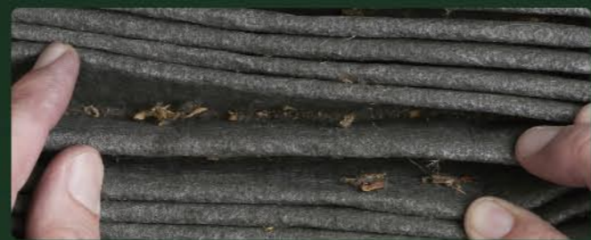
1年ほど使用したポーレンフィルター。目詰まりしてくると浄化性能が低下します。
