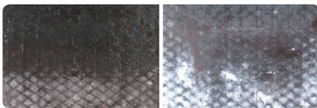
使用から1年が過ぎたバッテリーの内電極板の状態を比較してみました。左は年間走行距離1万kmのもの、右は同じく2500kmのもの。「サルフェーション」と呼ばれる劣化現象の進行が早いのは、走行距離の短い方のバッテリーです。
