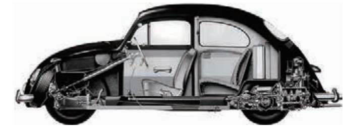
ビートルの透視図。これは1960年代のもですが、基本的な構造は1938年当時とほとんど変わりません。空冷の水平対向エンジンがリアの低い位置に置かれ、高いスペース効率を実現していることがわかります。
